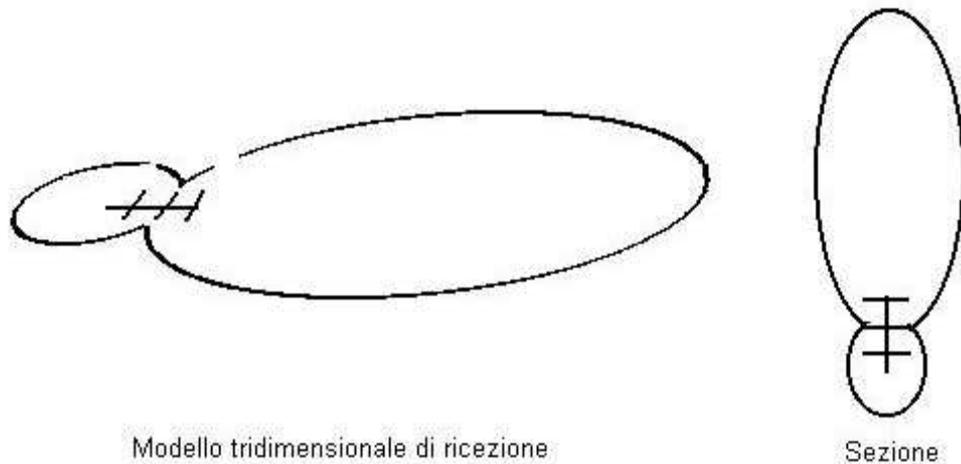
Figura 3.5 Schema di ricezione di un'antenna Yagi direzionale.
