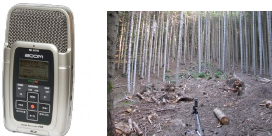
Figura 8. Registratore utilizzato per i rilievi e treppiede col registratore in un'area "schiantata"
